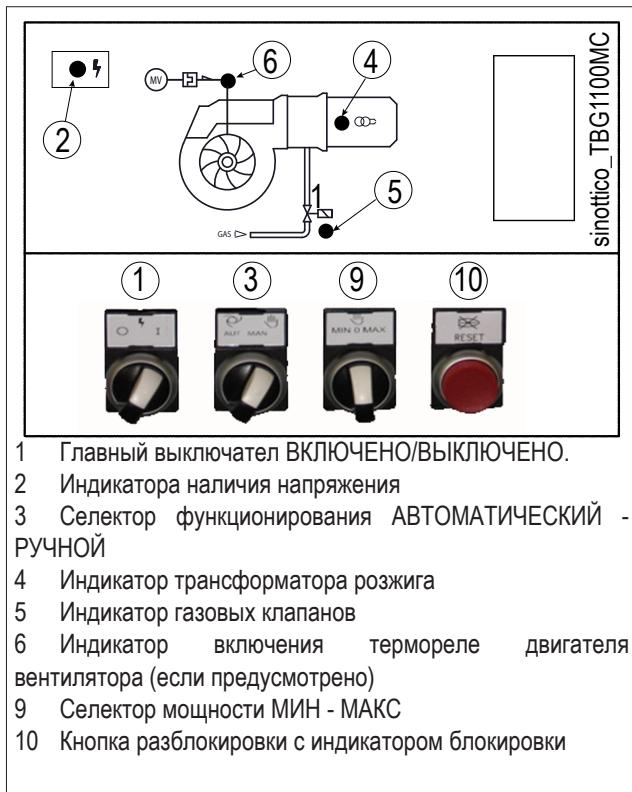
переключение реле давления воздуха (из замкнутого состояния без обнаружения давления на замкнутое состояние с обнаружением давления воздуха). Если реле давления воздуха не обнаружит достаточную величину давления, ни трансформатор розжига ни газовые клапаны не включатся, и блок управления остановится в положении блокировки -10
