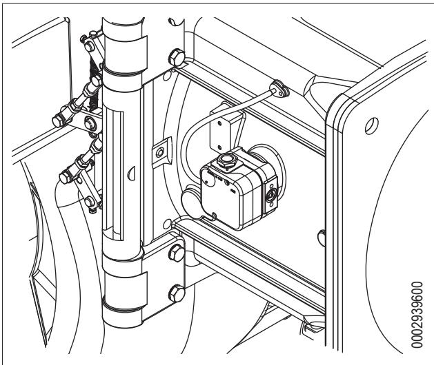
Контрольные прессостаты давления газа (минимального и максимального) служат для того, чтобы не позволять работать горелке в тех случаях, когда давление газа не входит в предусмотренные значения.
