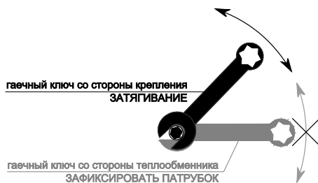
Рис. 5. Подключение к системе подачи теплоносителя
