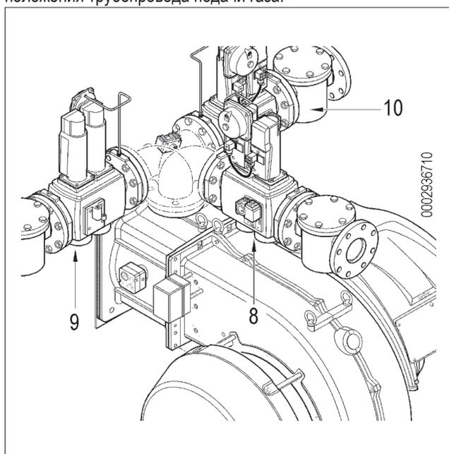
**ГЛАВНАЯ СХЕМА ГАЗОВОЙ РАМПЫ**
