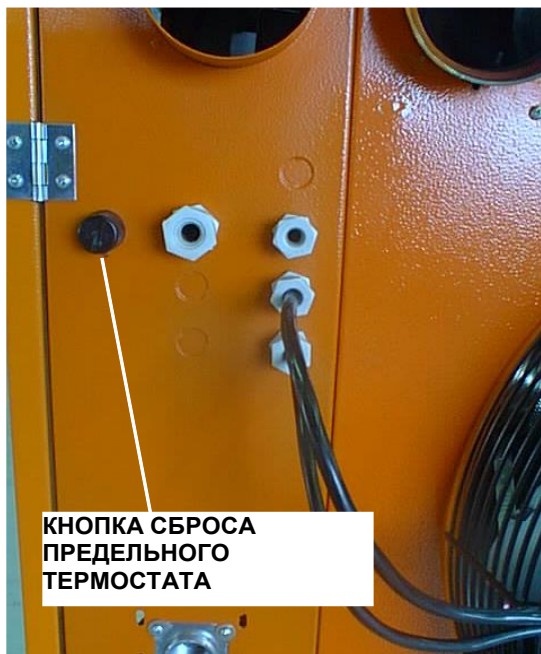
Рис. 30. Сброс предельного термостата.
